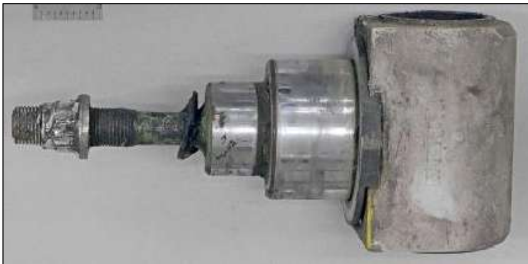
Fotografía No. 3 - Detalle general del Tee-bolt (TB)
