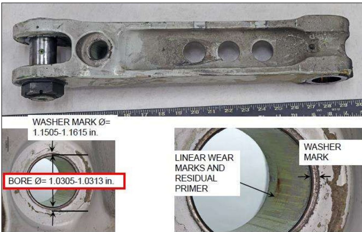
Fotografía No. 5 – Condición del Lower Drag Strut (LDS) y su diámetro interior
