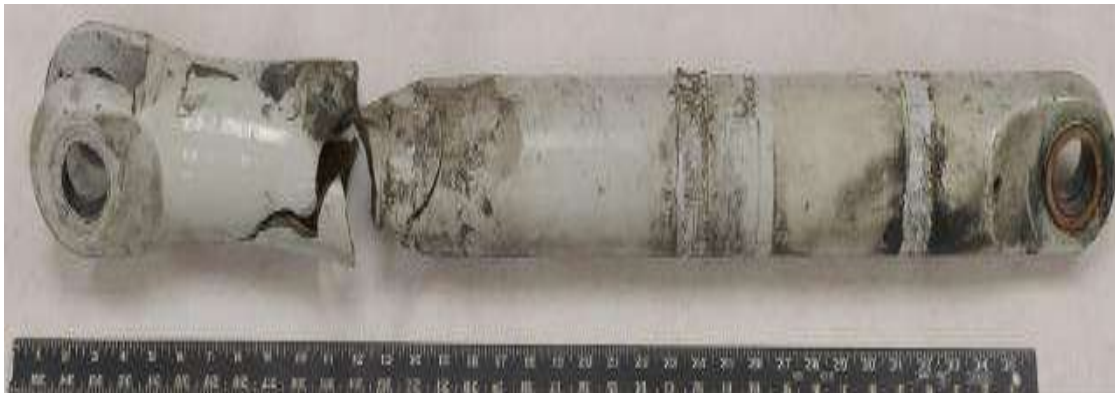
Fotografía No. 4 - Detalle general del Drag Strut (DS)
